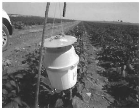
Fig. 97. El difusor de feromona se coloca en una pequeña jaula situada en el centro de la tapa. La trampa lleva dos enganches para colgarla.
