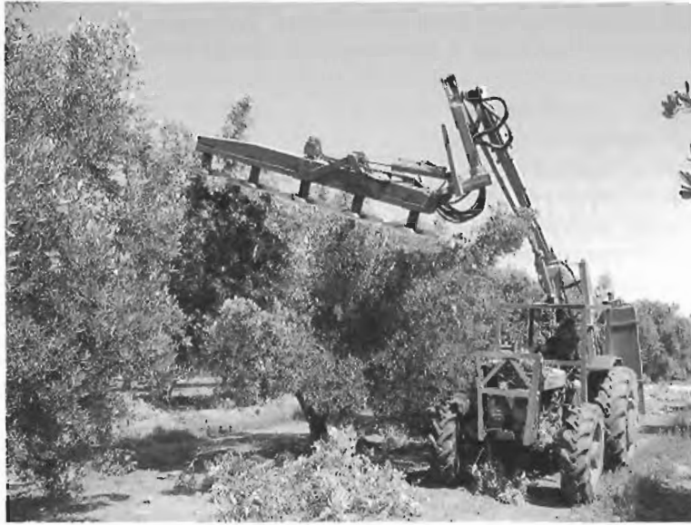
Máquina podadora de discos trabajando en Palma del Río (Córdoba) en una plantación intensiva de olivar de la variedad 'Picual' con marco 8x6 m. En este caso se realiza el rebaje en altura de la copa (topping).
