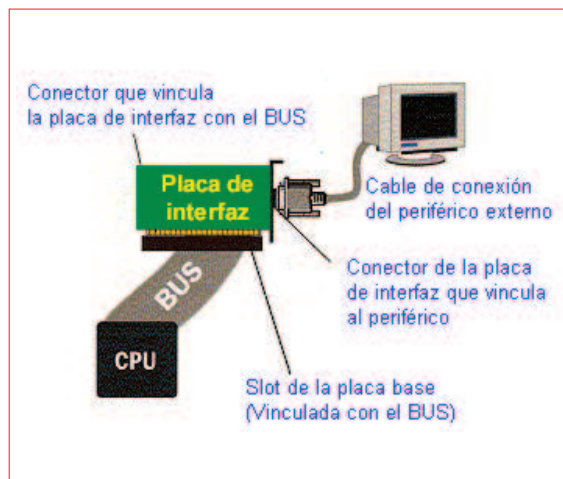
Fig. 30: Interfaz haciendo de puente entre la CPU y el periférico.
