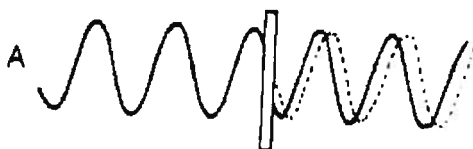
A) Efecto de un material transparente y no absorbente de mayor índice de refracción que el medio, introduciendo un cambio de fase (retardo).
