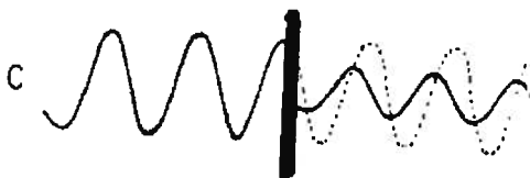
C) Efecto de un objeto transparente y absorbente. Provoca un retardo, pero también una disminución de la amplitud (intensidad).
