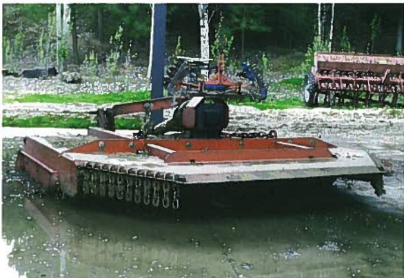
Foto 15: Desbrozadora para el control de la cubierta vegetal.
