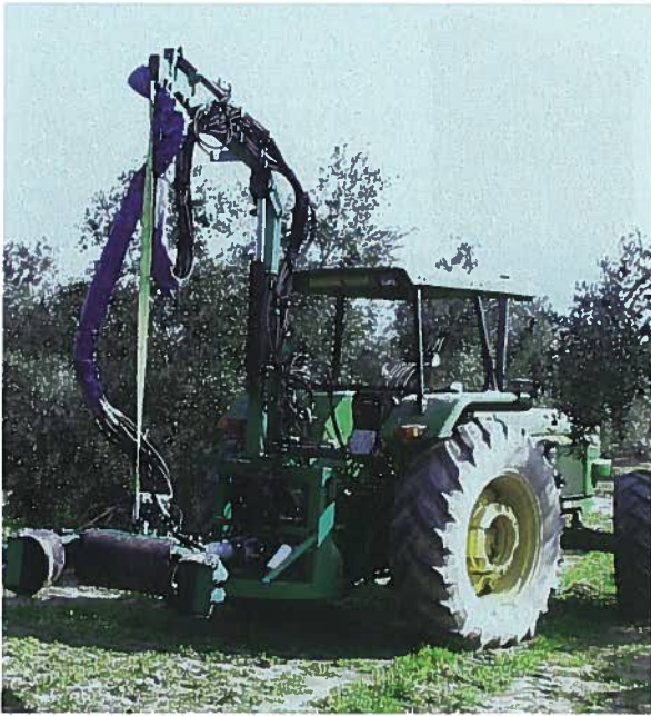
Foto 33: Vibrador montado sobre pluma.
