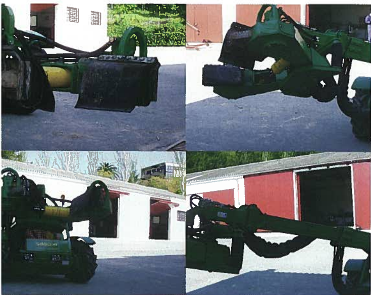
Foto 29, 30, 31, 32: Movimientos mecánicos de un vibrador.
