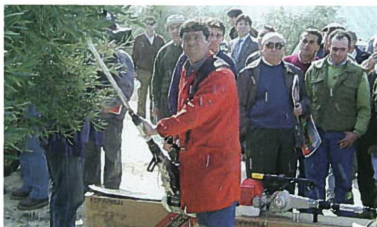
Foto 39: Vibrador manual trabajando.
