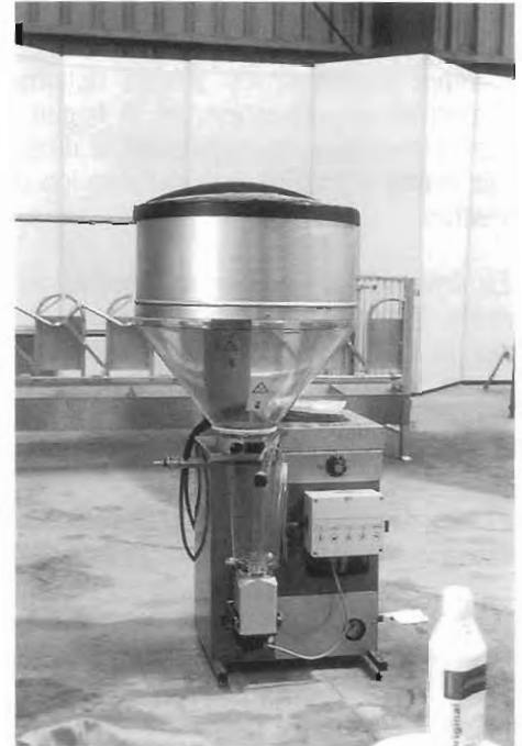
Robot para realizar lactancia artificial en pequeños rumiantes
