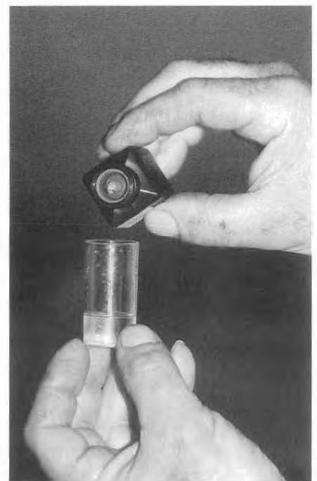
Aporte de reactivo en muestra de agua para control de la dosis de cloro
