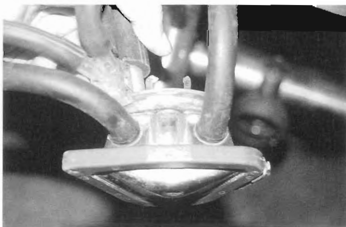
Colector común para el ordeño de pequeños rumiantes
