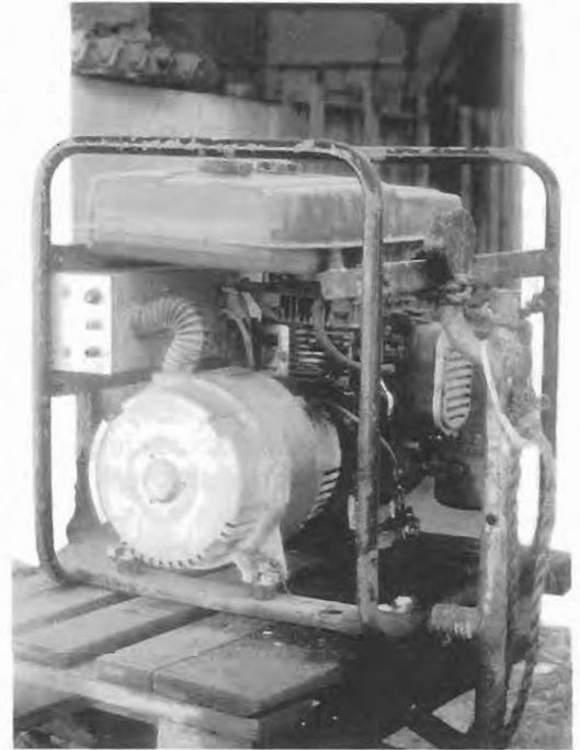
Grupo electrógeno para cubrir el suministro eléctrico básico en explotaciones donde no se cuenta con tendido eléctrico
