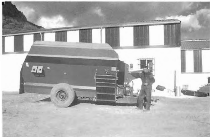
Carro mezclador para realizar y aportar raciones únicas
