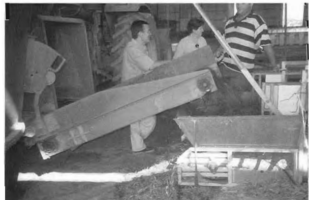
Aporte de ración única en cinta de alimentación desde carro mezclador
