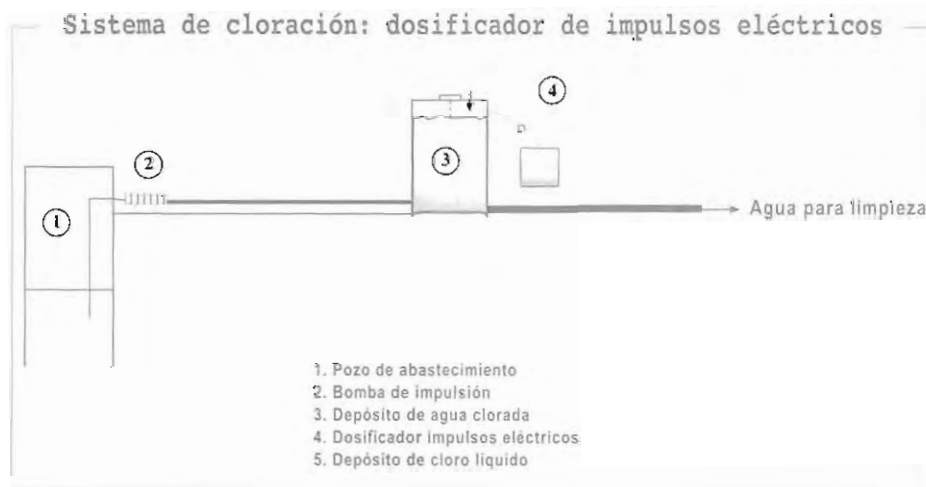
Figura 13.2. Sistema de cloración electrónico
