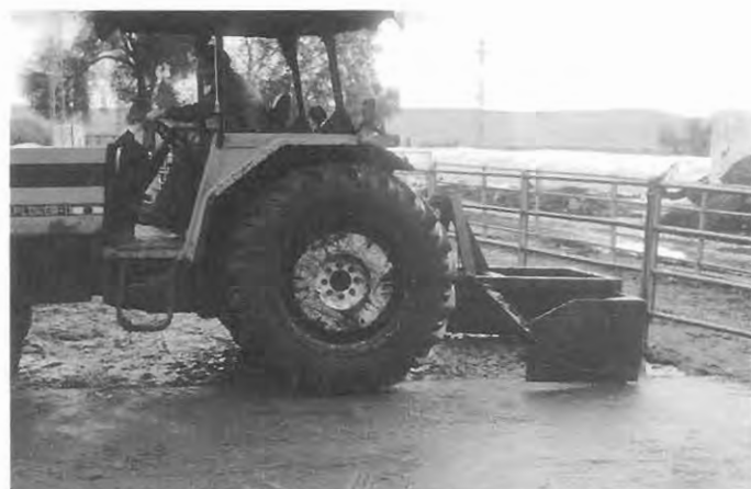
Arrobadera acoplada a tractor para la limpieza de superficies pavimentadas
