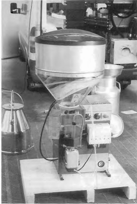
Robot para realizar lactancia artificial en pequeños rumiantes
