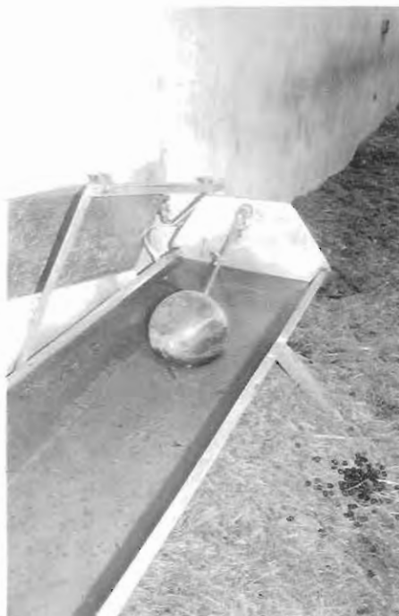
Detalle de boya y grifo de llenado en un bebedero de nivel constante
