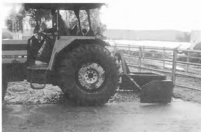
Arrobadera acoplada a tractor para la limpieza de superficies pavimentadas
