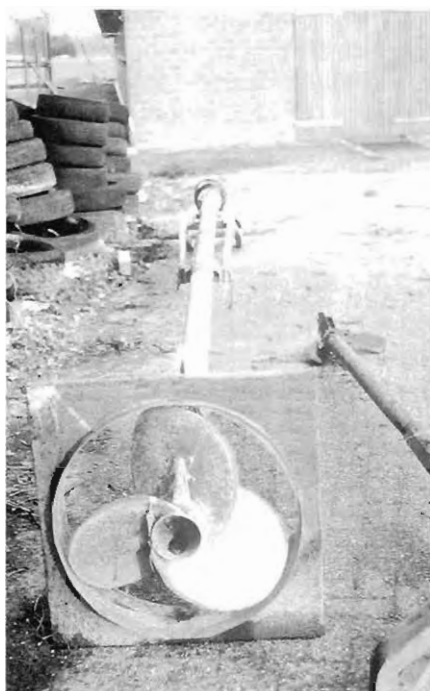
Agitador de purines para homogeneización antes de uso como abono
