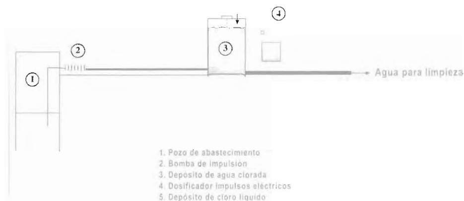
Figura 13.2. Sistema de cloración electrónico
