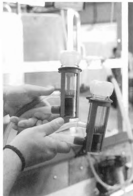
Colector individual con sistema de corte automático de vacío
