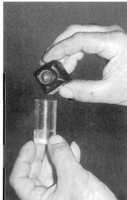
Aporte de reactivo en muestra de agua para control de la dosis de cloro
