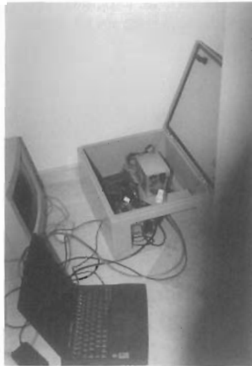
En esta fotografía se muestran los equipos empleados como centro de control. Se puede apreciar el ordenador portátil y el cuadro conteniendo los módems y emisora de radio.
