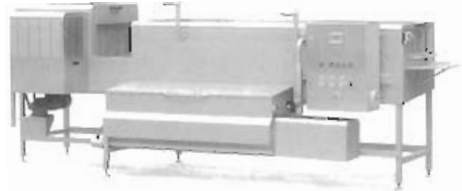
Túnel de lavado de cajas Fuente: MIMASA
