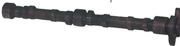
Fig. 23. Camón correspondiente a la válvula de escape del diagrama fig. 22. Detalle de un eje de camones completo.
