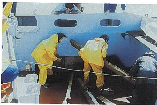
Apuntalamiento sobre mamparo vertical
