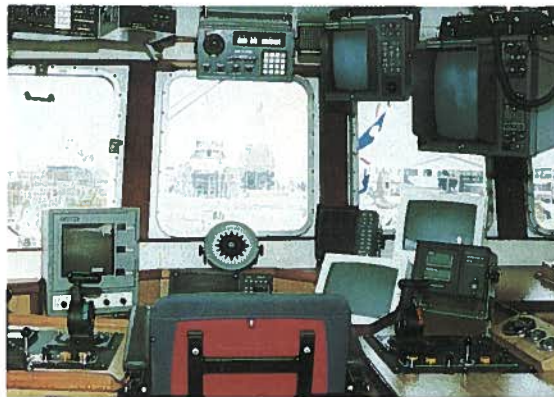
Puente de mando de un buque pesquero. En estos buques es de vital importancia disponer de varias sondas
