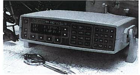
Equipo de navegación por satélite. Cobertura mundial pero no continua, por lo menos con los satélites TRANSIT.
