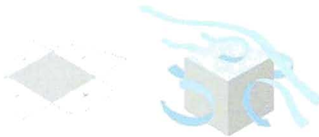
EFEECTO DE VIENTO SOBRE UN VOLUMEN PRISMÁTICO. CARAS CON SOBRE Y BAJO PRESIÓN
