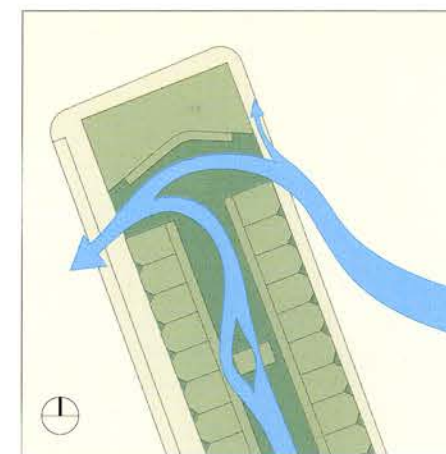
Esquema de penetración y circulación del viento a través de los espacios abiertos del edificio.
