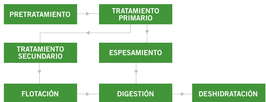
Gráfico 3. Esquema de funcionamiento de una EDAR tipo (no incluye el tratamiento terciario)
