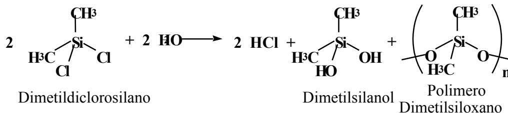
Diagrama 7: Hidrólisis del dimetildiclorosilano
