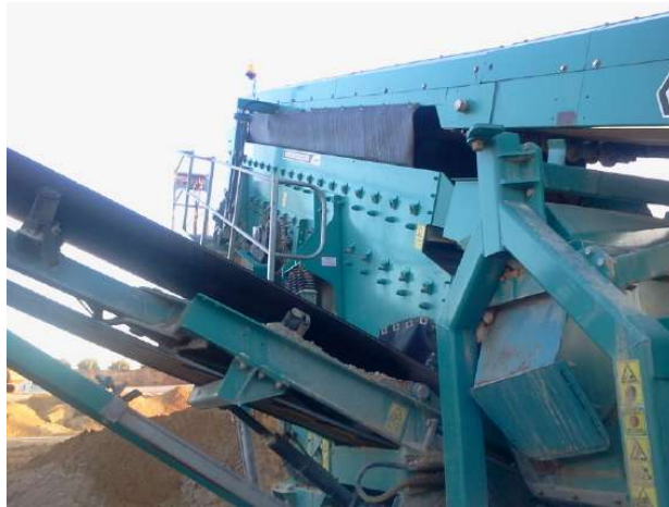
Detalle de una cinta lateral y la criba.
