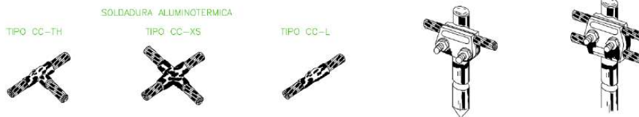
Figura 6.- Uniones malla de tierra
