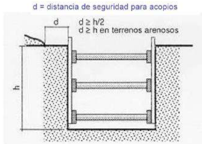
Figura 2.- Distancia de seguridad entibaciones
