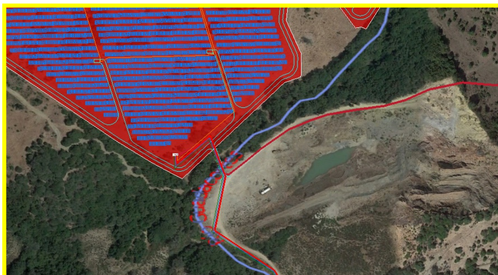
Ilustración 56-Cruce de cauces fluviales por la Línea de evacuación
