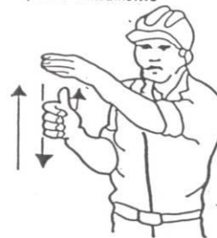
4 Levantar el aguilón o pluma lentamente
