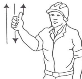
4 Levantar el aguilón o pluma lentamente
