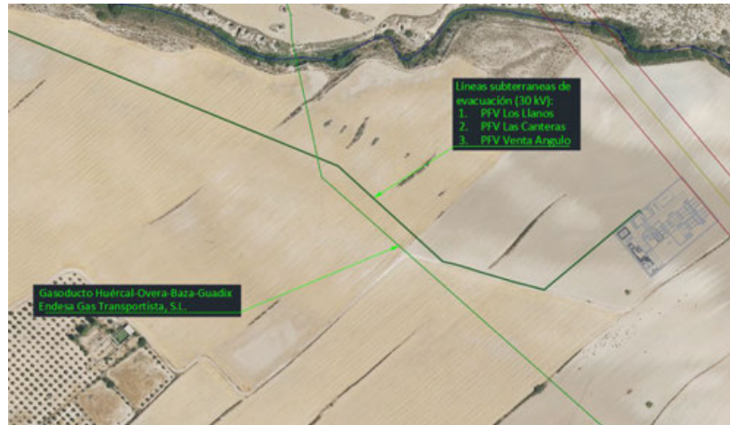
Imagen 10. Planta sobre ortofoto del cruzamiento con gasoducto.
