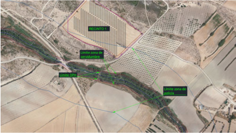
Imagen 7. Vista aérea de afecciones de instalaciones a DPH de la rambla de Cucar.
