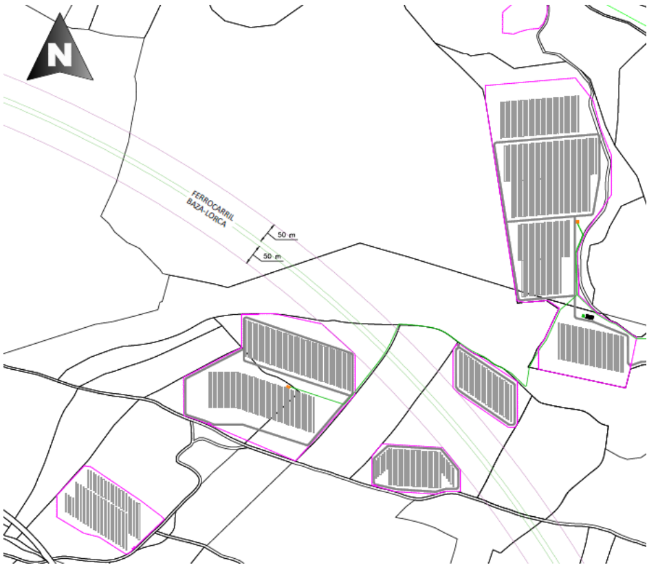
Imagen 9. Afecciones a la línea de ferrocarril proyectada.
