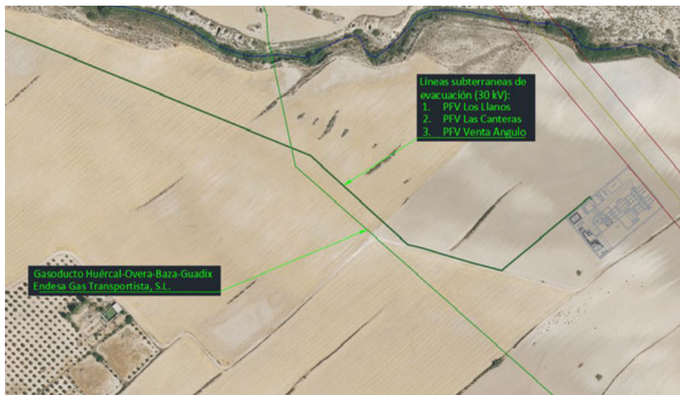
Imagen 10. Planta sobre ortofoto del cruzamiento con gasoducto.
