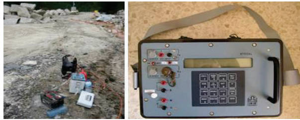
Foto: Equipo de tomografía eléctrica
