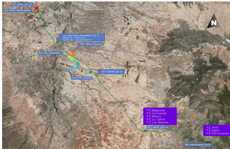
Figura 2.1.b. Instalaciones colectoras de evacuación. Fuente: Modificados de los Proyectos de Ejecución de las Plantas Fotovoltaicas Venta Angulo, Los Llanos y Las Canteras. TT.MM. Baza y Caniles (Granada).
