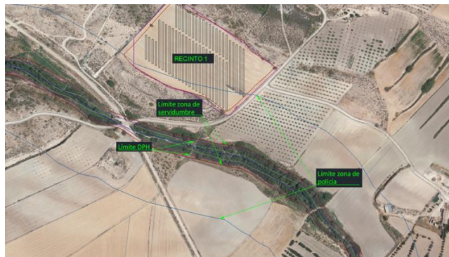
Figura 3.1.18.f. Vista aérea de afecciones de instalaciones a DPH de la rambla de Cucar. Fuente: Modificado del Proyecto de Ejecución de la Planta Fotovoltaica Los Llanos. TT.MM. Baza y Caniles (Granada).
