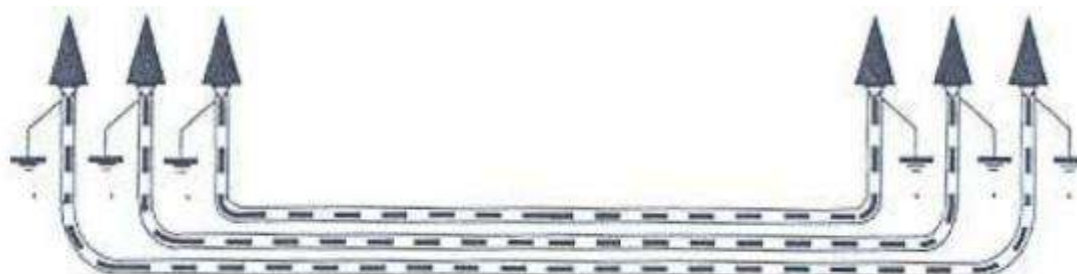
Figura 27: Puesta a tierra de cubiertas metálicas.
