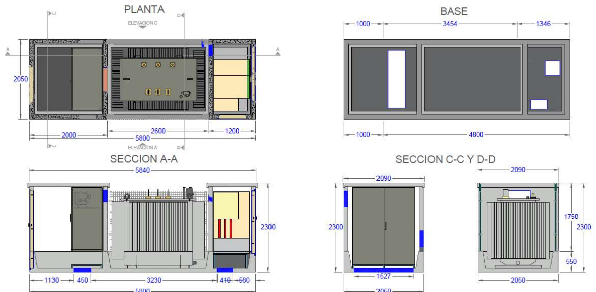
Figura 18.- Detalle Centro de Transformación
