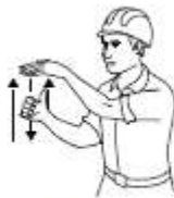
4 LEVANTAR EL AGUILÓN O PLUMA LENTAMENTE
