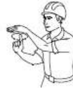
3 LEVANTAR LA CARGA LENTAMENTE
