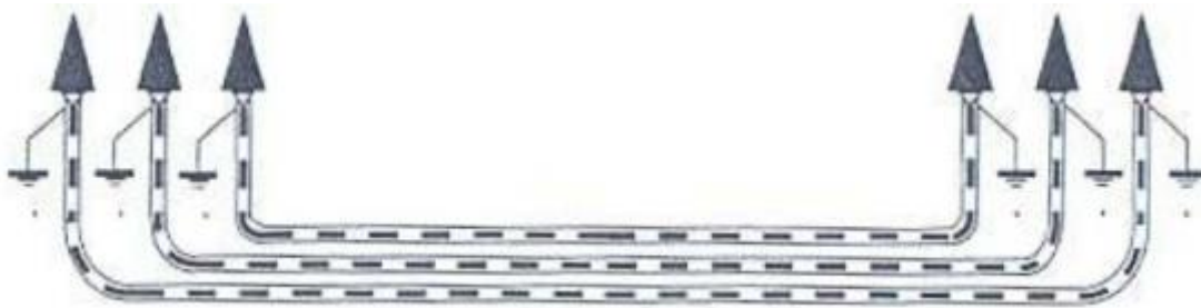
Figura 23: Puesta a tierra de cubiertas metálicas.
