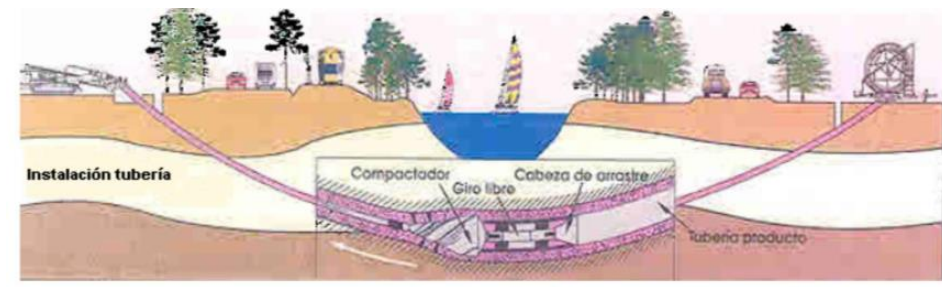
Detalle Instalación de la Tubería
