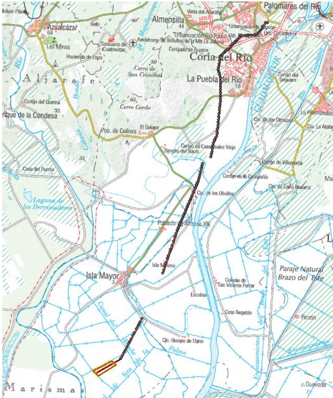
Ilustración 2. Planta fotovoltaica y línea eléctrica aérea de evacuación de 66 kV asociada.
