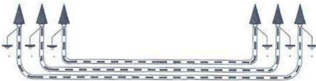
Figura 25: Puesta a tierra de cubiertas metálicas.
