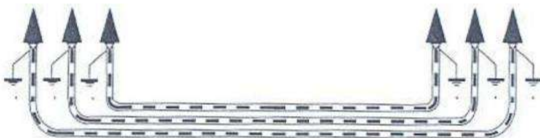
Figura 25: Puesta a tierra de cubiertas metálicas.
