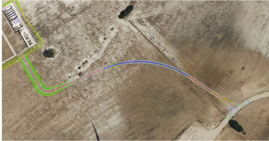
Imagen 6. Camino de acceso a la SET 66/30 kV "La Concepción".
