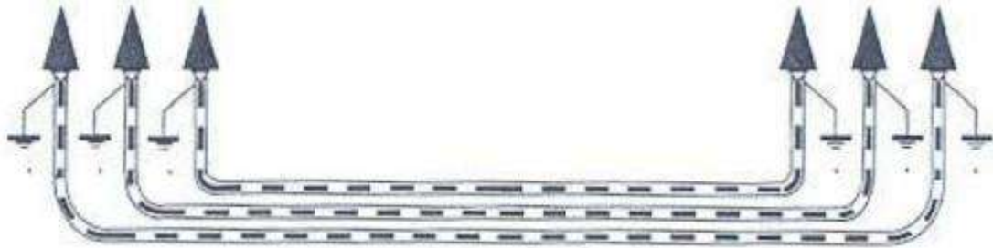
Figura 27: Puesta a tierra de cubiertas metálicas.
