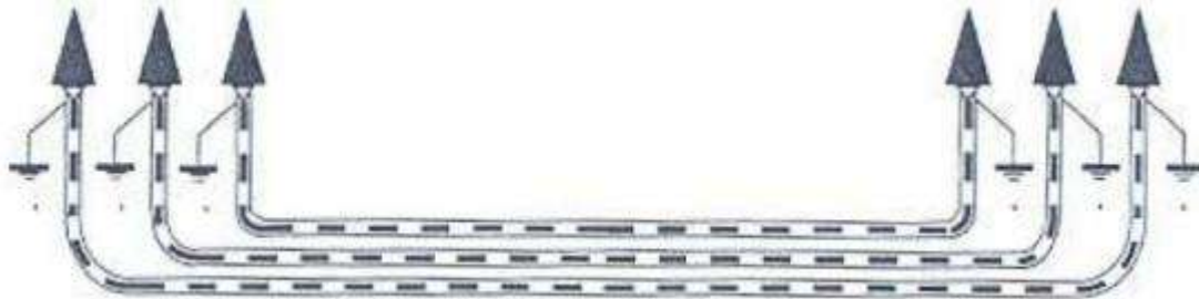
Figura 26: Puesta a tierra de cubiertas metálicas.
