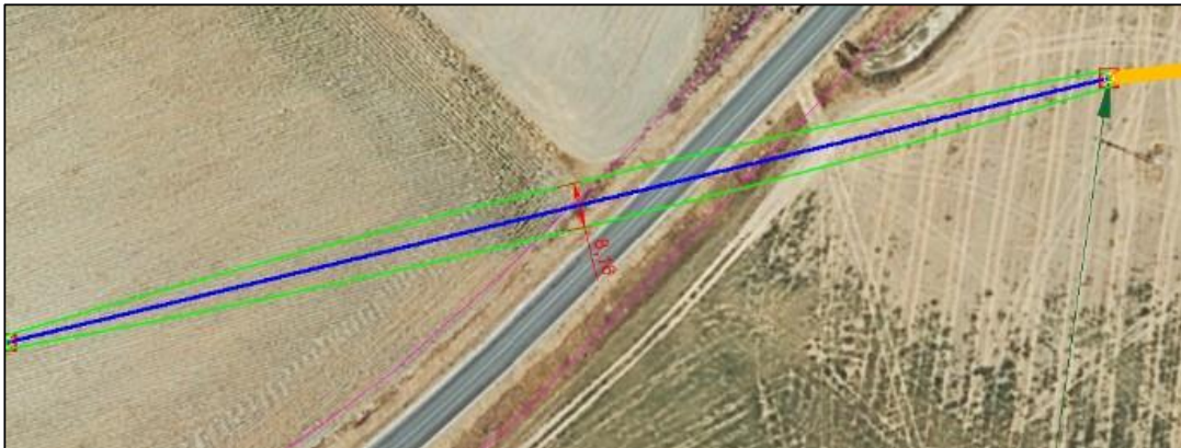
Ilustración 4. Anchura máxima de vuelo de vano sobre vía pecuaria.
