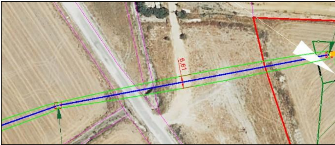
Ilustración 3. Anchura máxima de vuelo de vano sobre vía pecuaria.
