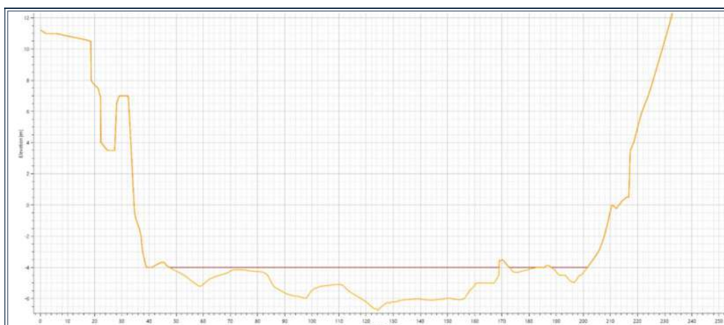
Figura 24. Relleno a cota -4- PK 0+000
