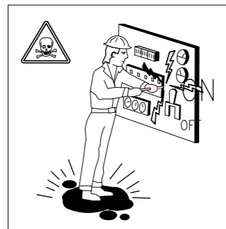
REPARACION DE EQUIPOS BAJO TENSION
