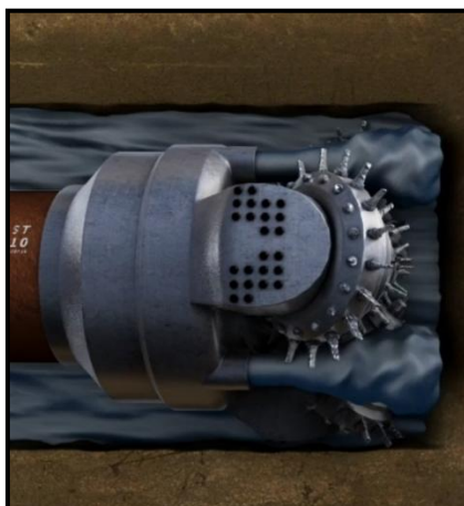
Cabezal de perforación piloto
