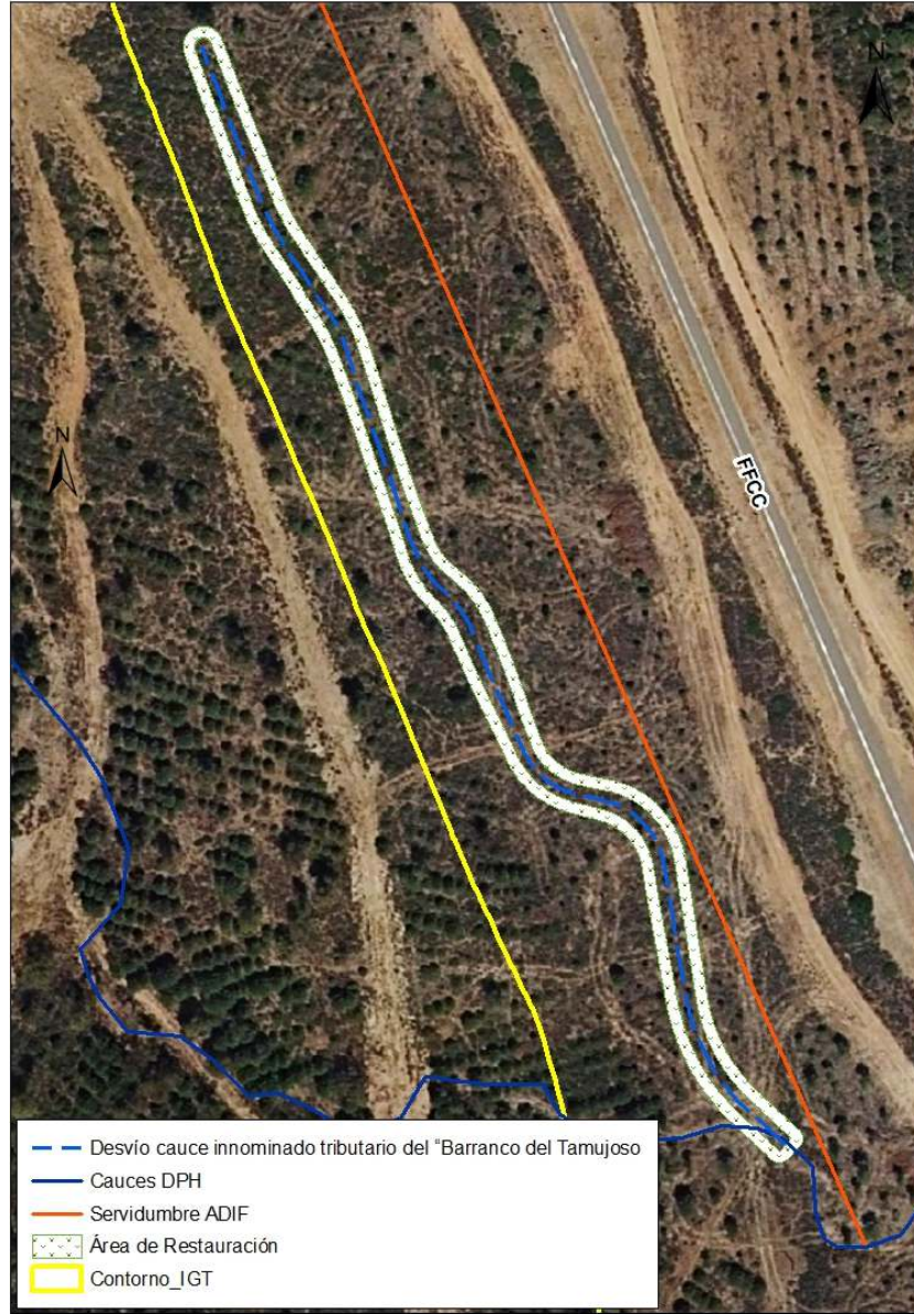
Figura AVIII 2. Detalle del área de restauración desvío del nuevo cauce dph
