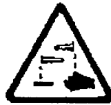
RIESGO DE CORROSION
