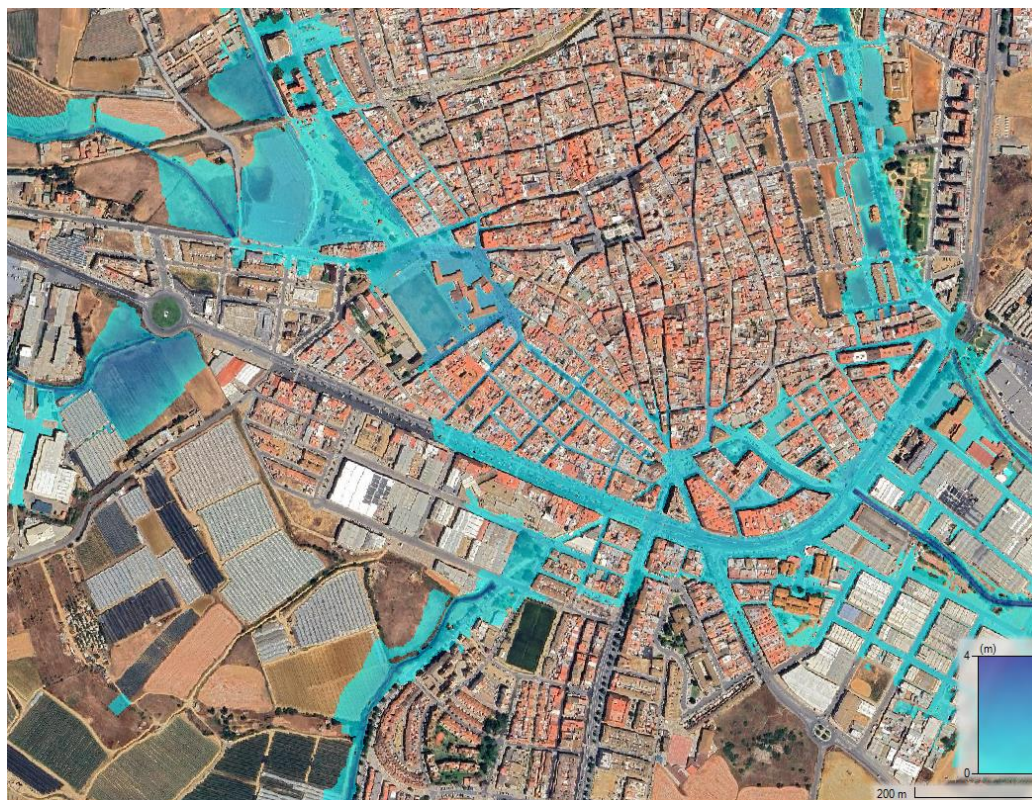
Figura 17. Ejemplo de calados obtenidos en la modelización de los tramos ES064_ARPS_0040 y ES064_ARPS_0041 para T100.
