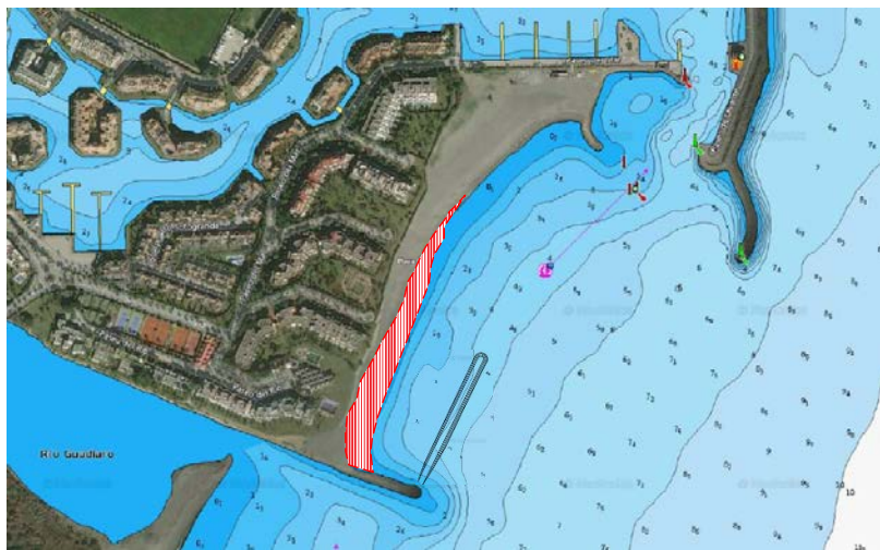
Figura 6. Planta Alternativa B. Relleno artificial de arena con prolongación en cierre del espigón (dique sumergido).
