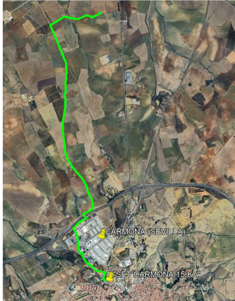
Ilustración 1- Trazado de la línea de evacuación
