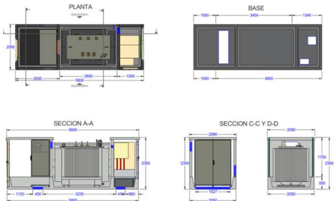
Figura.- 2.Detalle Centro de Transformación
