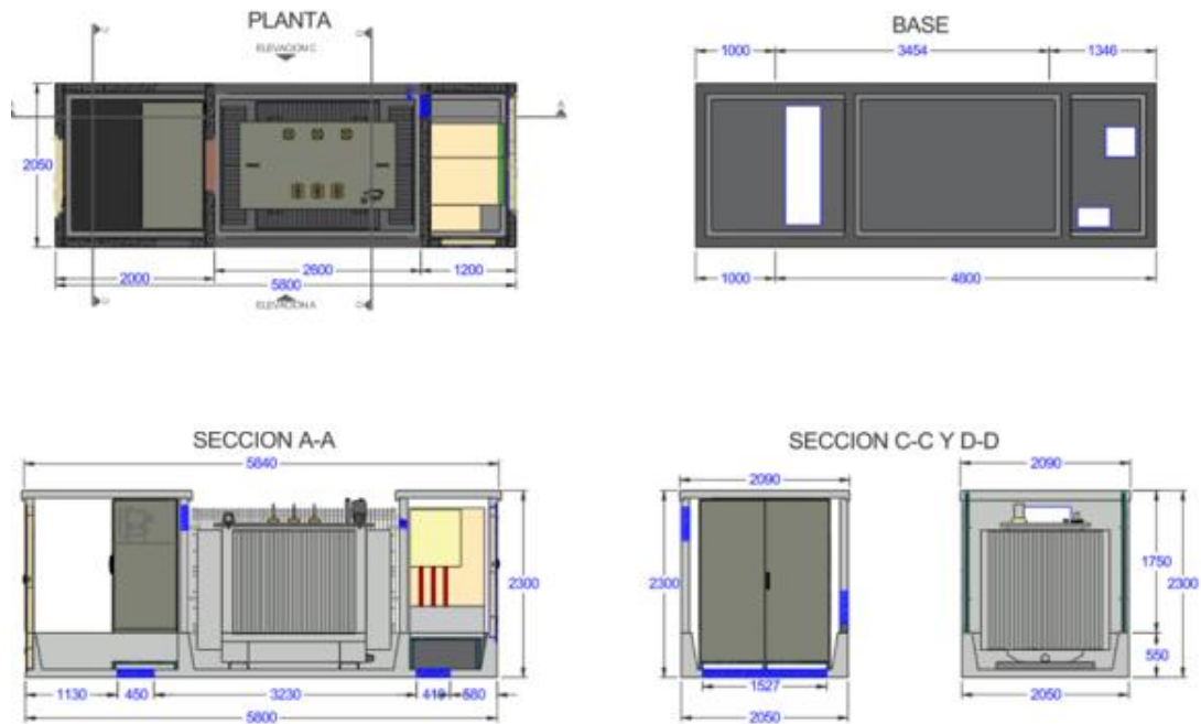
Figura 19. Detalle Centro de Transformación
