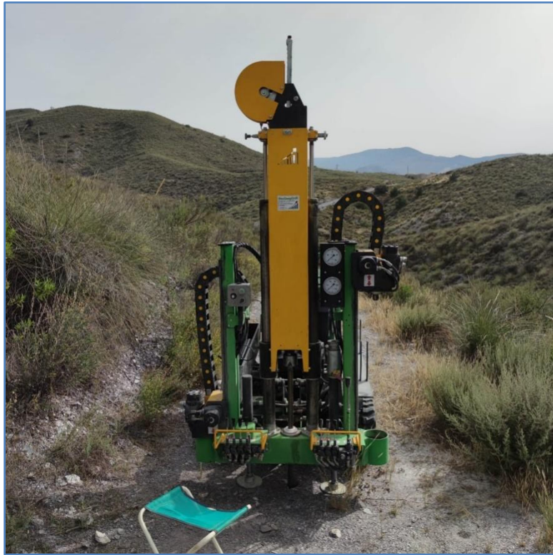
Emplazamiento penetrómetro P-7.
