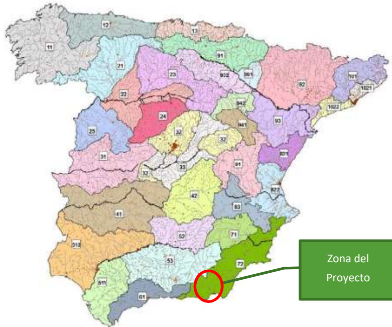
Figura 12: Regiones consideradas para la caracterización del coeficiente corrector del umbral de escorrentía s/ Norma 5.2-IC "Drenaje Superficial".
