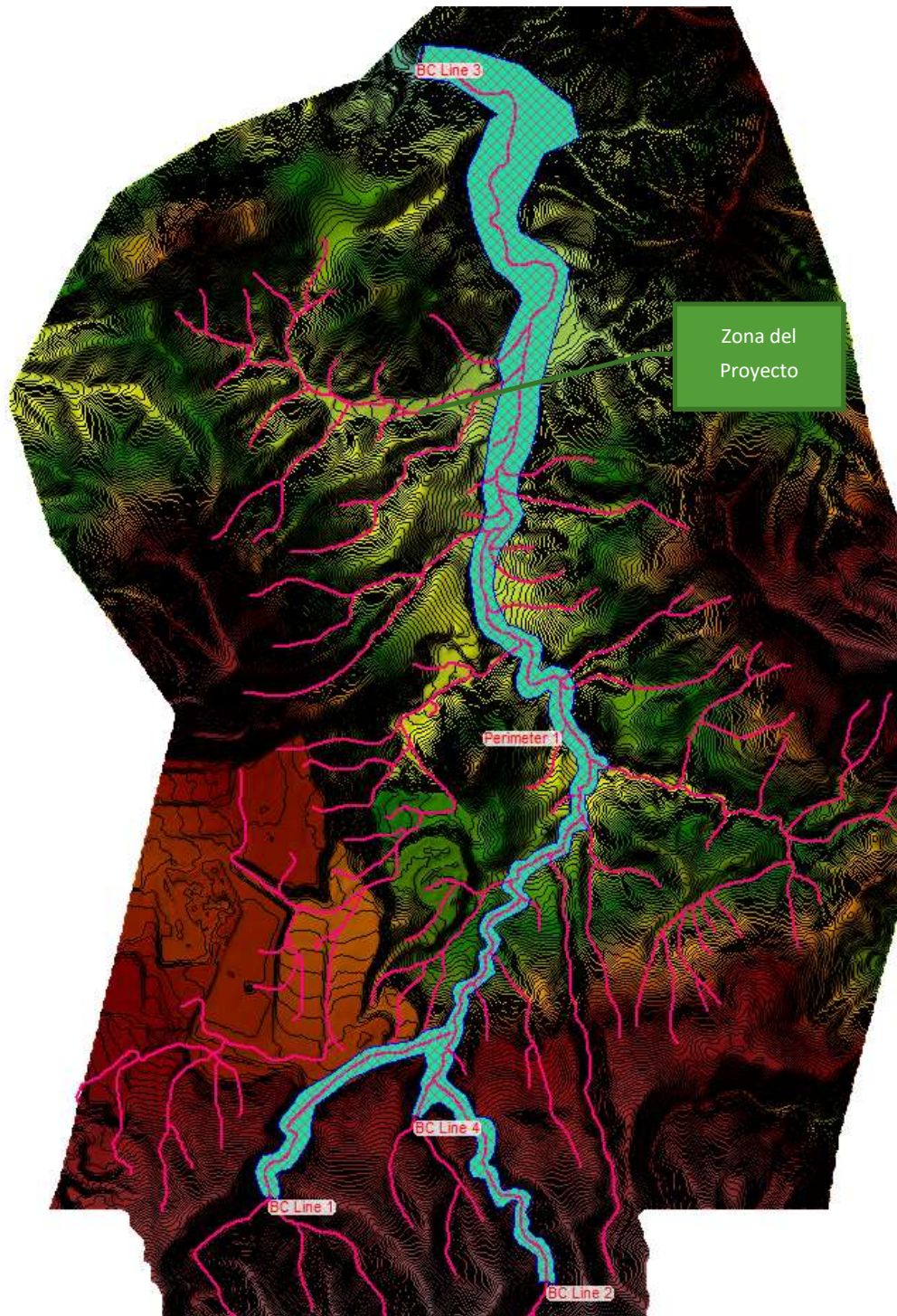
Figura 14: Vista área 2D y líneas de ruptura añadidas.
