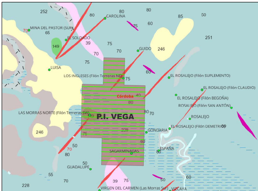
Figura 14. Mapa geológico del IGME con el perímetro del P.I. “Vega” incluyendo los indicios mineros de la base de datos BDMIN. Las 24 líneas (en verde) de dirección N90E corresponden a los 26 km lineales para cubrir el P.I. con la geofísica terrestre (polarización inducida).
