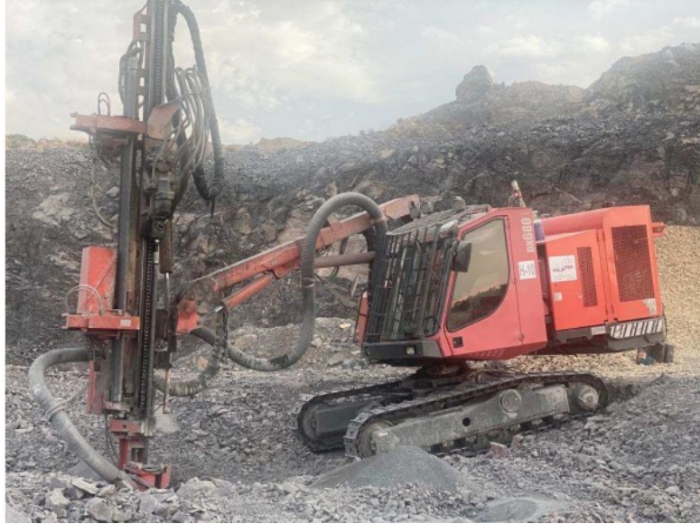
Figura 2. Perforadora de rotoperusión con martillo en cabeza para sondeos de polvo.
